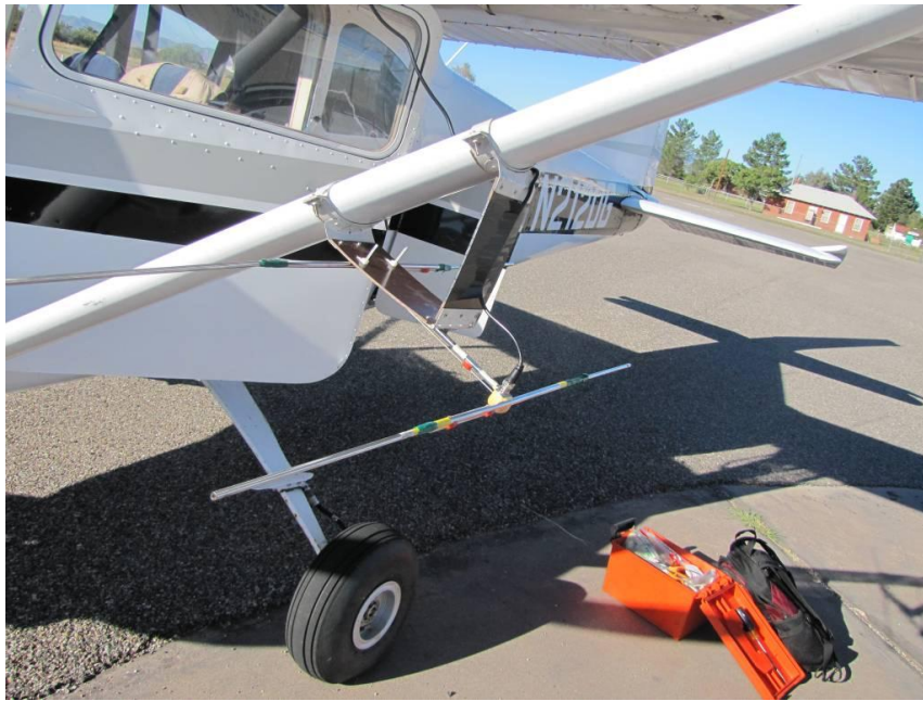
Figura 18.- Aeroplano de ala alta en el cual se han colocado antenas Yagui de dos elementos sujetas al soporte del ala. Se debe colocar una antena de las mismas características a cada lado del aeroplano. Las antenas deberán ser conectadas a un módulo en el que alternativamente se puedan escuchar la señal recibida por la antena izquierda, la derecha o ambas al mismo tiempo (Fotografía N. Lara).
