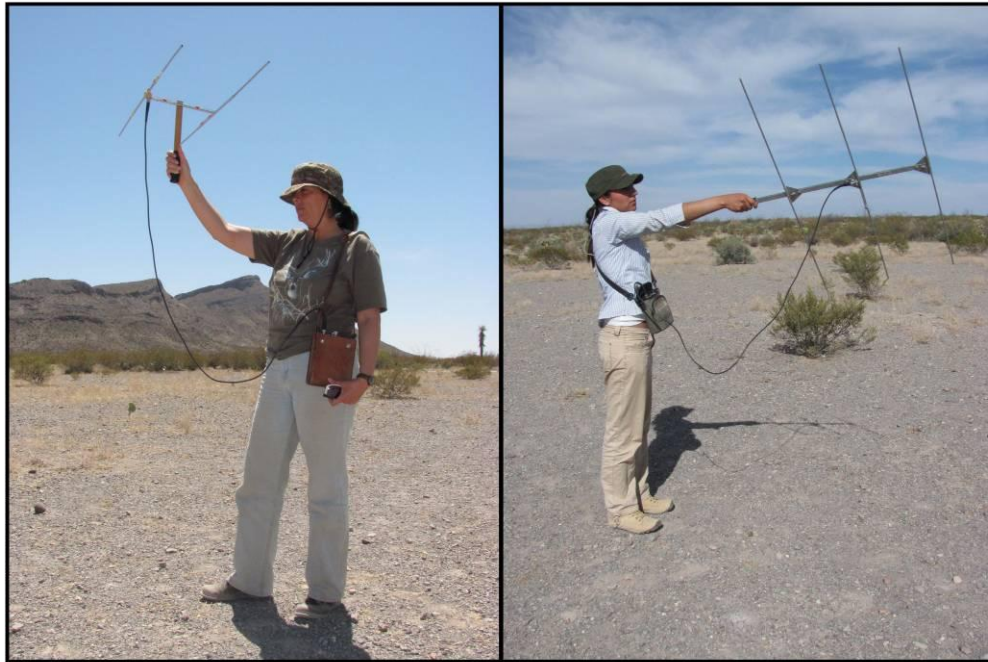
Figura 11.- Fotografías de subsistemas de recepción con antenas Yagui portátiles de dos elementos (izquierda) y tres elementos (derecha). La ganancia de las antenas Yagui se hace mayor conforme se incrementa el número de elementos. Así mismo, el patrón de recepción de la señal se vuelve mucho mas estrecho y preciso conforme se incrementa el número de elementos en la antena Yagui (Fotografía M. Hidalgo).
