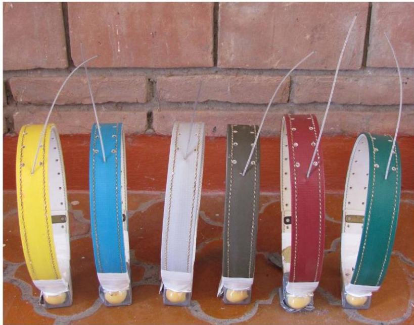
Figura 6.- Radio collares en los que se observa antena de propagación de látigo. En estos collares en particular es posible observar que el material de montaje presenta diferentes colores. Esto es para que en caso de que los animales equipados sean observados sean fácilmente reconocibles de otros organismos también equipados. Los colores utilizados en los radio collares deben poseer características que no disminuyan el éxito reproductivo o la sobrevivencia de los organismos equipados (Fotografía M. Hidalgo).
