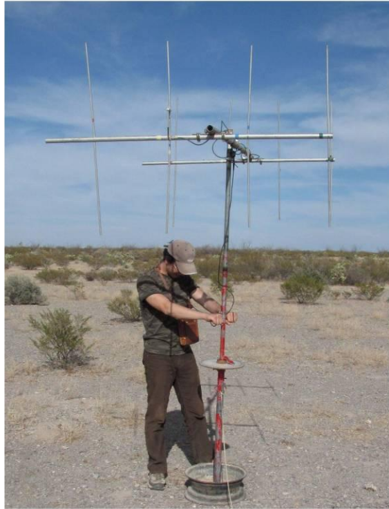
Figura 12.- Sistema de Pico-Nulo montado en una estación fija. El sistema de pico nulo se conforma por dos antenas Yagui con exactamente las mismas características, montadas en forma paralela y conectadas entre sí. El sistema pico nulo sirve para obtener de forma muy precisa la dirección en la que se encuentra un radio collar (Fotografía M. Hidalgo).
