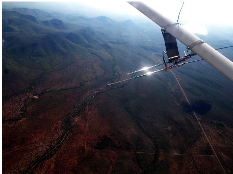
Figura 19.- Cuando se realiza radio telemetría desde aeroplanos, una vez que se localiza la dirección de la señal, es necesario que realizar círculos concéntricos cada vez mas cerrados hasta determinar el punto más probable donde se localiza el animal (Fotografía N. Lara).
