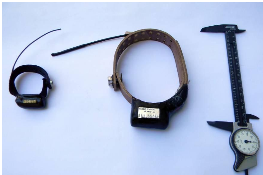
Figura 4.- Fotografía de dos radio collares para equipar a un mamífero chico (izquierda) y mediano (derecha). Ambos radio collares cuentan con las mismas características internas del radio transmisor, variando únicamente la fuente de poder. La diferencia se debe al peso máximo que un mamífero chico puede cargar en comparación con uno mediano. Las consecuencias de esta reducción en la fuente de poder son menor potencia en la emisión de la señal, así como menor duración de la pila del radio collar (Fotografía M. Hidalgo).
